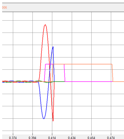
Abbildung 132: Distanzschutz: Auslöseverhalten beim 2pE-Kurzschluss mit LE (voreilend)
